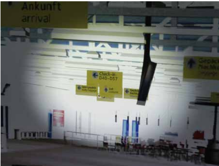
Die nachfolgende Abbildung zeigt die Bildüberlagerung mittels Fokussierungsbeamers mit einer Auflösung von 1600 x 1200. Die sich im Fokus befindlichen Schilder wurden wesentlich schärfer und kontrastreicher dargestellt.
