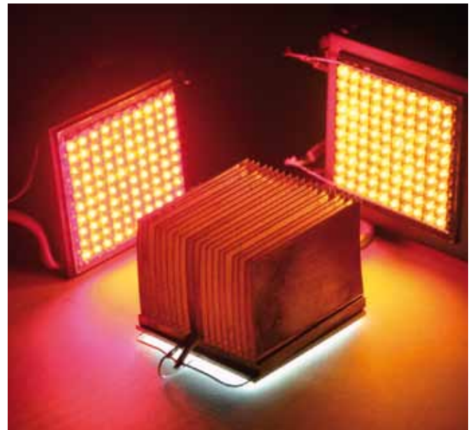
Kühlkörperoptimierung für Hochleistungs-LED Module, z. B. Unterwasserscheinwerfer bis 250 W
