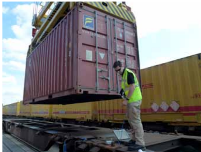
Abb. 27: Erfassung von Schallsignaturen auf Grund von Umgebungseinflüssen während Containerumschlages in einem Terminal
