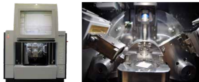
Abb. 37: Modernes, kompaktes Röntgendiffraktometer (D2-Phaser) zur Phasenanalyse von polykristallinen Pulvern und dünnen Schichten
