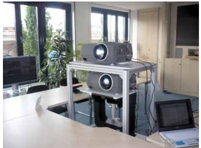
Abb. 11: Testumgebung für Grundsystems mit Anordnung der Beamer incl. Versuchsschwenkeinrichtung
