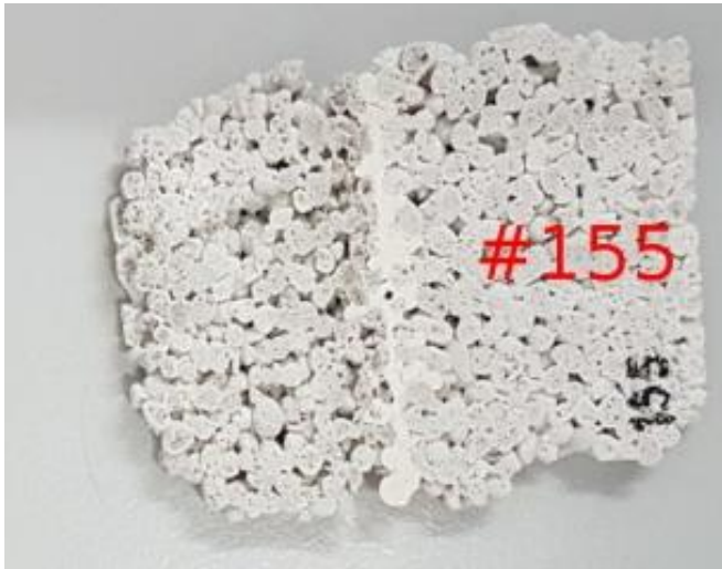
Abb. 2: Photographie des Querschnitts des geklebten Prüfmusters #155 (Wasserglas mit \text{Al}(\text{OH})_3 und Kaolin). Die anorganische Zwischenschicht (heller Streifen in der Mitte) verbindet zwei UleBra-Platten.
